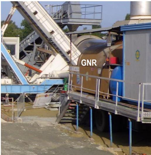
Aire de rétention pour cuves à bitume et réservoir AD Blue
