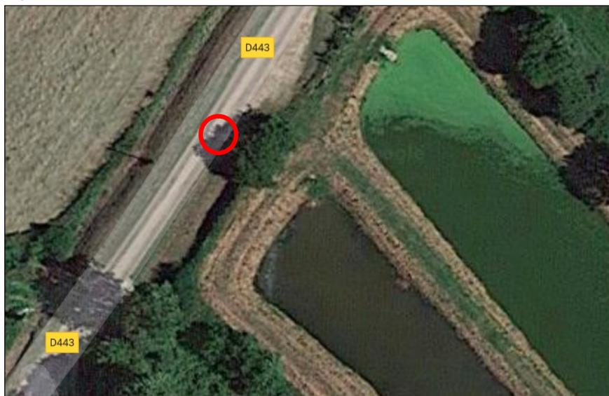
Le poste de transfert recevra les effluents venant du bourg de Méautis depuis le réseau gravitaire existant sous la RD443 puis les enverra jusqu'aux casiers du filtre planté de roseaux.
