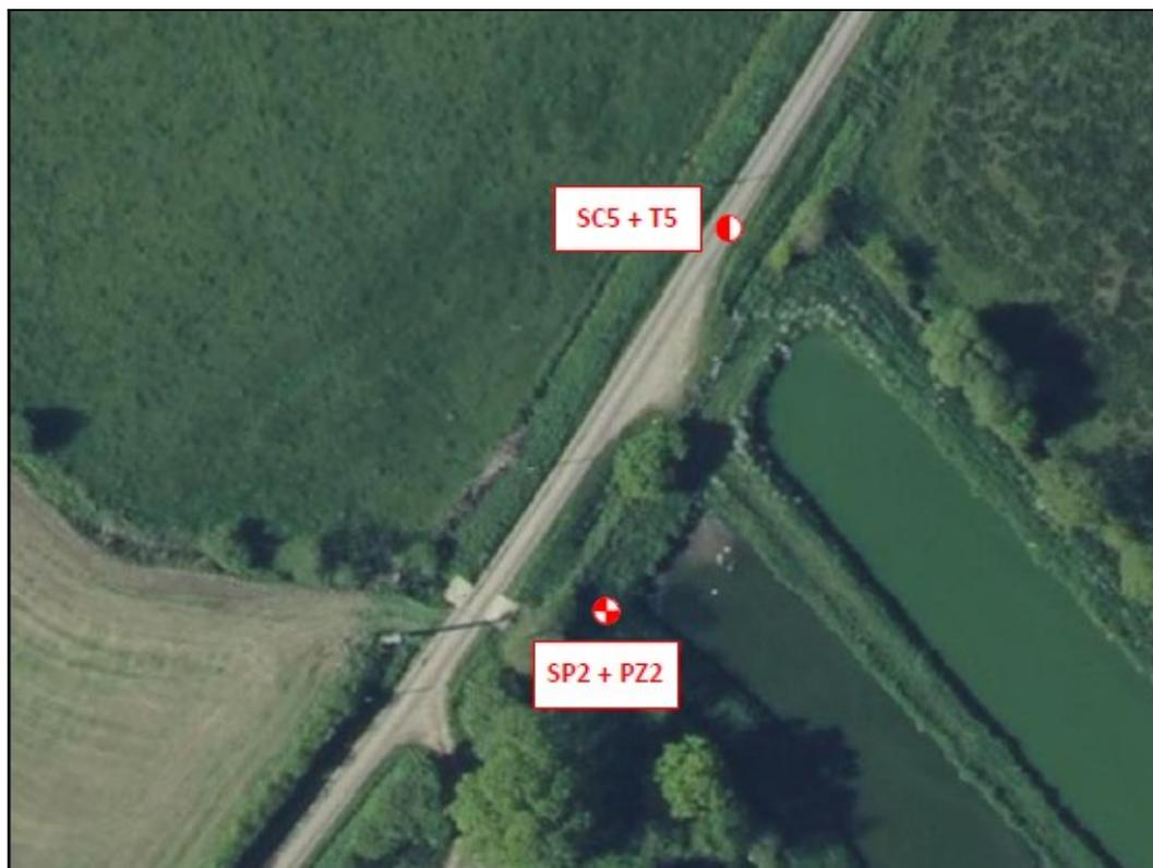
Figure 16 : Implantation des carottages de chaussée – STEU
